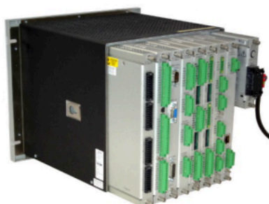
Figure 4: Mini Rack Back View – I/O Modules
